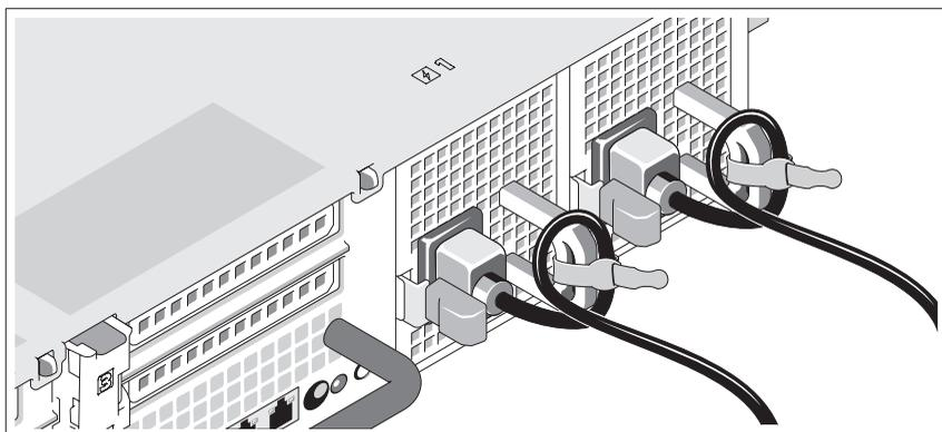
システムの電源ケーブルをループ状に曲げ（図を参照）、付属のストラップでブラケットに固定します。
