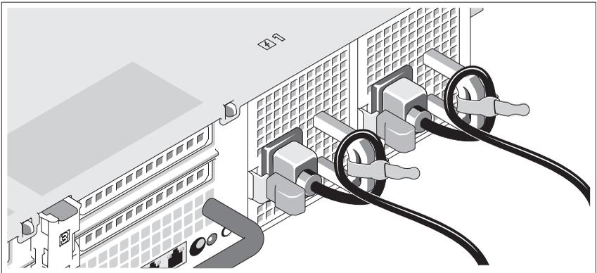
Tekuk kabel daya sistem hingga membentuk loop seperti ditunjukkan dalam gambar dan kencangkan kabel ke braket menggunakan pengikat yang disediakan.
