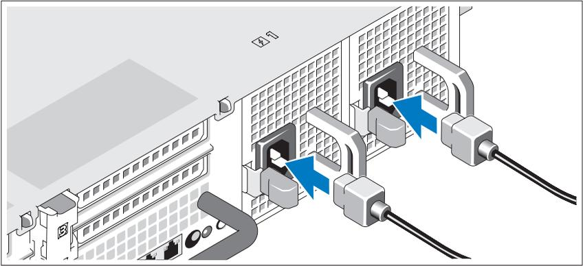
Sambungkan kabel daya sistem ke sistem.
