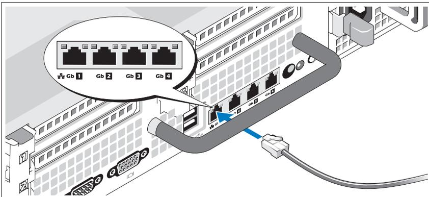
Sambungkan kabel Ethernet ke salah satu konektor Ethernet di bagian belakang sistem.
