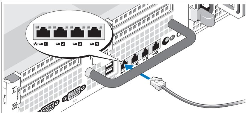
将以太网电缆连接到系统背面的其中一个以太网连接器。
