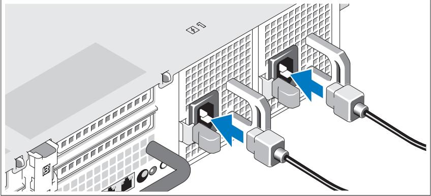
将系统的电源电缆连接到系统上。
